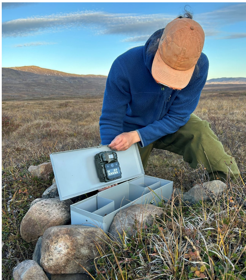
Figur 1. En kamerafelle består av en metalltunell med et viltkamera i taket. Kamerafella steines inn for at den skal være stabil og for at steinene skal filtrere snøen slik at den ikke trenger inn i kamerafella og blokkerer sikten til kameraet.
